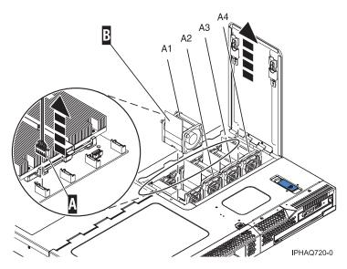
Figure 18. Removing a fan
