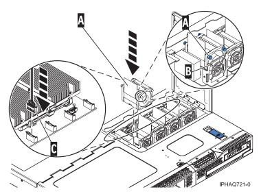
Figure 19. Installing a fan
