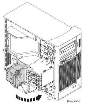
Figure 9. Closing the fan assembly
