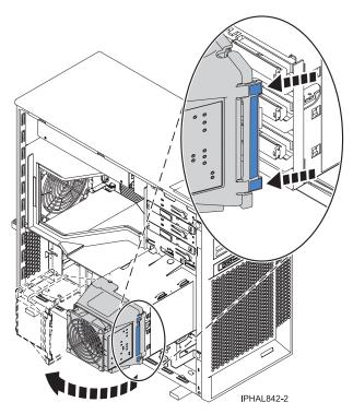
Figure 2. Opening the fan assembly
